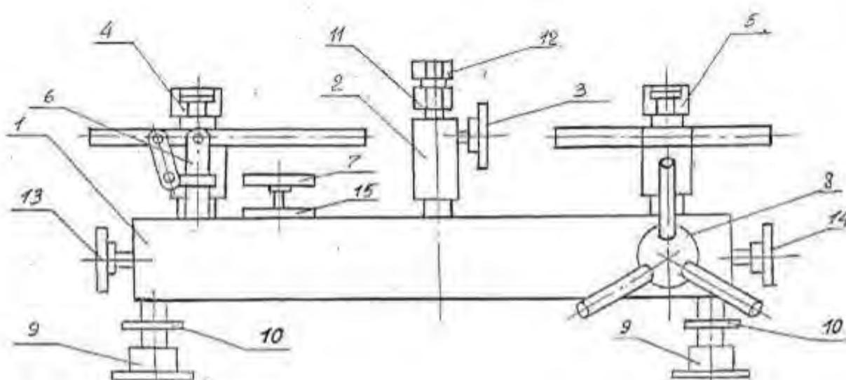
1 Станина. 2. Стойка центральная. 4. Захват безрезьбовой левой. 5. Захват безрезьбовой правой. 6. Насос ручной скальчатый. 8. Пресс. 9. Опоры. 10. Винты регулировочные. 11. Штуцер. 12. Гайка. 3, 7, 13, 14. Вентили. 15. Бачок.
