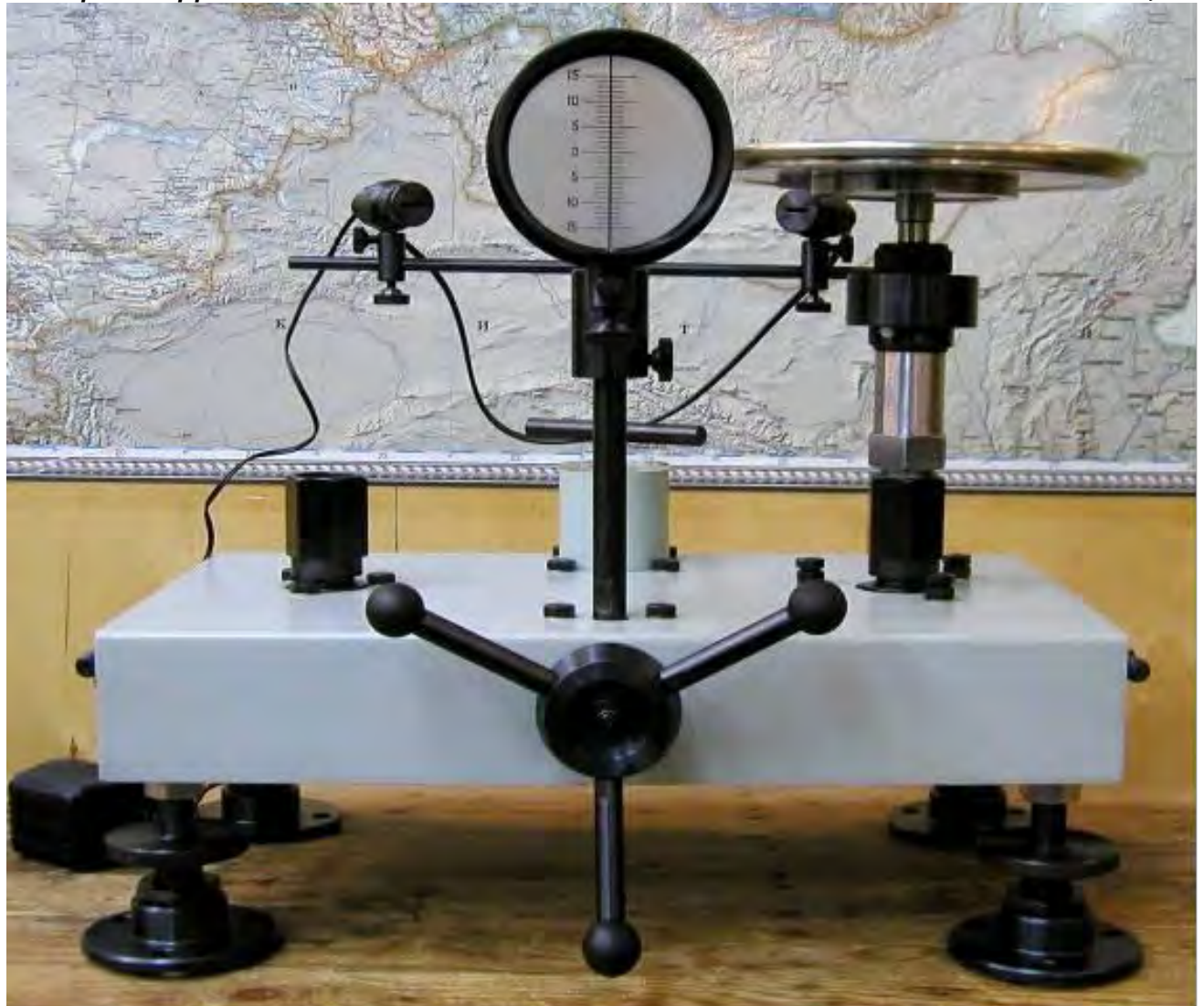
ОБЩИЙ ВИД МАНОМЕТРА ГРУЗОПОРШНЕВОГО МП-60 КЛАССА ТОЧНОСТИ 0,01
